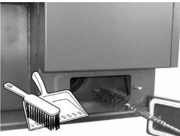
Vorführung der Reinigung des Rauchkanals mit Drahtbürste.
