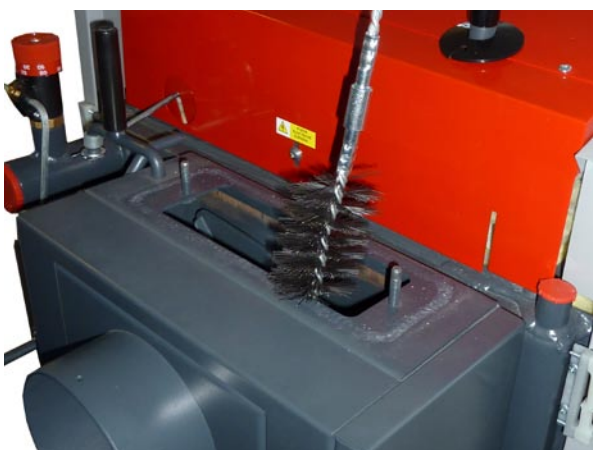
Vorführung der Reinigung des Rauchkanals mit Drahtbürste.
