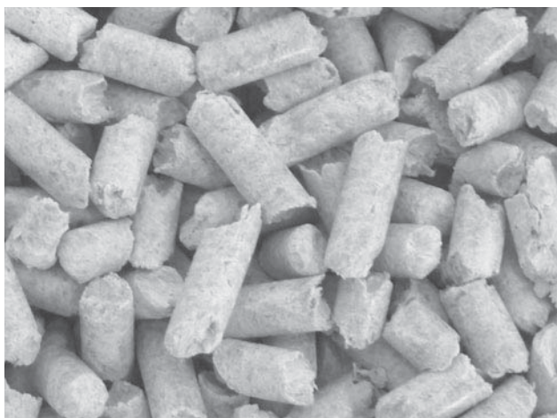
Hochwertige Holzpellets – Weißpellets ohne Schwarzkunkte (Rinde)
